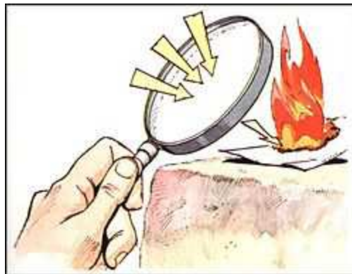
Concentración de calor radiado del sol, por procedimientos ópticos.
